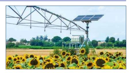
L'énergie solaire est transformée en électricité par l'intermédiaire de panneaux photovoltaïques installés sur l'unité centrale. L'orientation et l'inclinaison des panneaux sont réglables afin d'optimiser la production énergétique. L'énergie produite est stockée sur des batteries qui fournissent à leur tour l'électricité alimentant le pivot.
