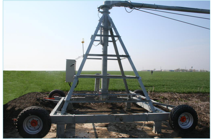
PIVOT DEPLACABLE SUR ROUES
