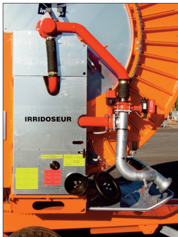
Válvulas de regulación + VA
