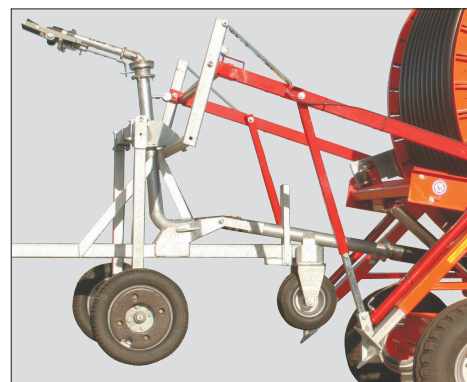
Levantamiento acoplado con dispositivos de anclaje (tipo premium)
