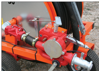
Turbina funcionando con caudal débil sobre la caja de velocidad
