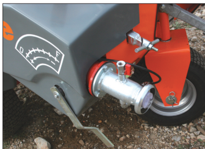
Regulación de velocidad por by pass
