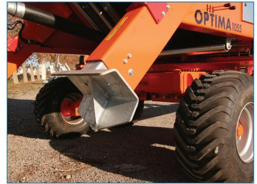
Patas de anclaje hidráulicas
