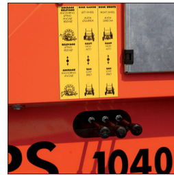
Mandos hidráulicos laterales patas y levantamiento y tornamesa giratoria
