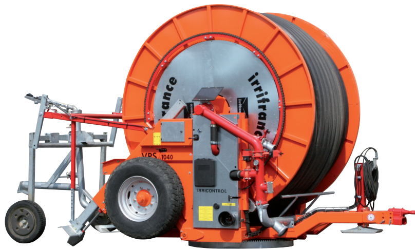
Mandos hidráulicos laterales patas y levantamiento y tornamesa giratoria
