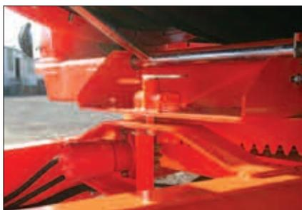
Hydraulische Drehung Oberteil
