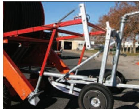
Hydraulische Hubvorrichtung gekoppelt mit dem Anheben der Verankerungssporne (Typ Premium)
