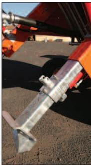
Hydraulische Oberteildrehung und hydraulische Verankerungssporne
