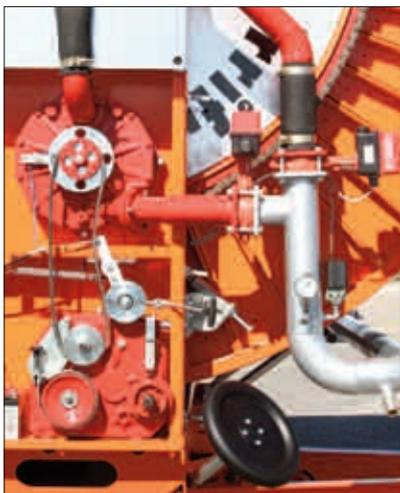
Einheit Einstellventile + Automatikventile
