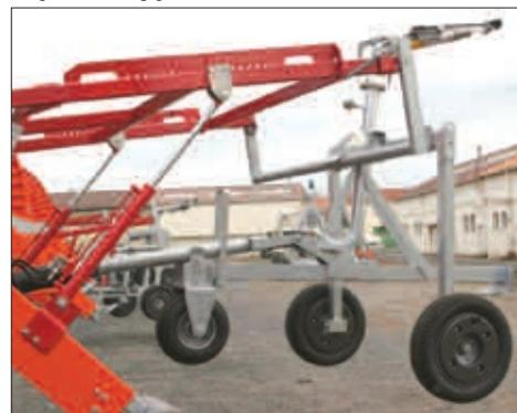
Hydraulische Hubvorrichtung bei der Serie 2000 unabhängig gesteuert
