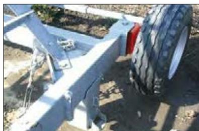
Auf vier Räder oder Kufen montiert, kann der Turm in Längsrichtung fortbewegt werden und ist besonders für das Beregnen von Parzellen geeignet, die in die Fruchtfolge einbezogen werden.
