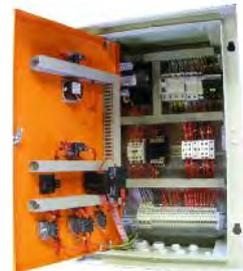
ist für die Pumpensteuerung der Beregnungsdüngung, der Beregnung mit Chemikalien konzipiert worden und kann mit weiteren Optionen ausgestattet werden: Gleitschutz, Blitzschutzeinrichtung, Timer, doppeltem Dosiergerät für zyklischen Einsatz, etc...
