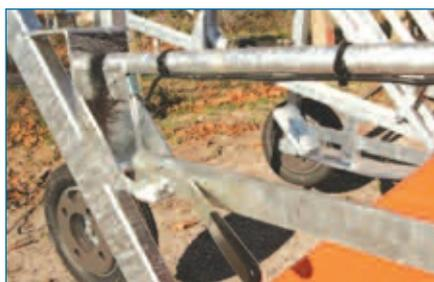
Stopsensor und Rahmenverriegelung
