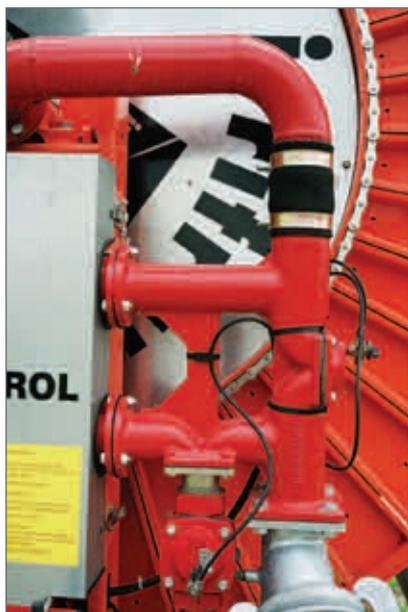
Verteilungsrohr mit integriertem Ventil
