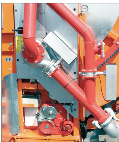
Motorización con válvulas eléctricas
