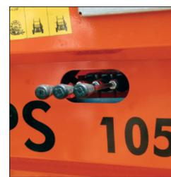
Distribuidor hidráulico lateral
