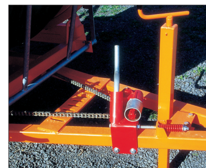
Option rotation tourelle et cric mécanique
