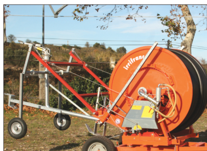
Relevage manuel du traîneau par treuil
