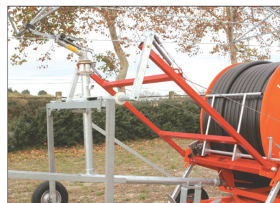
Accrochage automatique en fin d'arrosage
