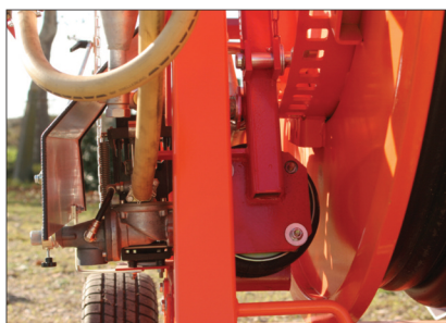
Bras moteur actionné par soufflet pneuride 8"
