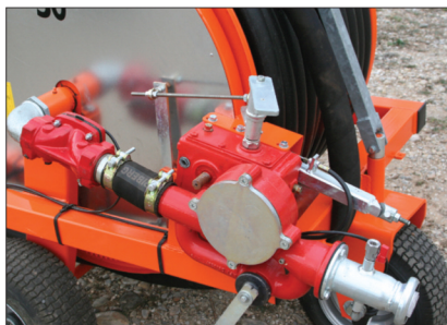
Turbine faible débit flasquée sur boîte à vitesse
