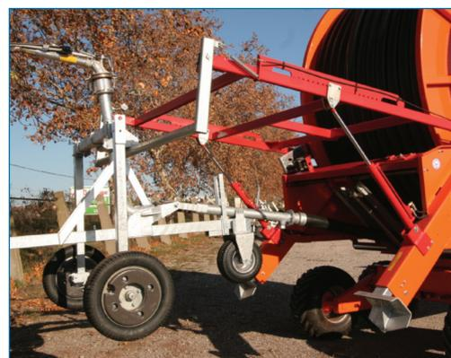
Traîneau série 2000 & cadre relevage hydraulique
