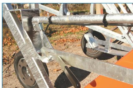
Capteur arrêt et verrouillage cadre
