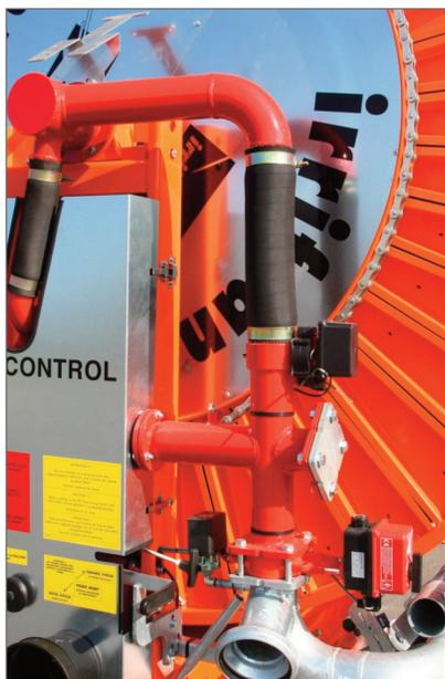
Tubulure alimentation avec vanne intégrée
