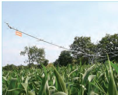
Для расширения своей линейки систем кругового орошения и линейных систем орошения, компания Irrifrance выпустила на рынок складную консоль. Эта система оптимизирует орошаемую площадь при помощи систем кругового орошения, избегая при этом препятствий, деревьев, столбов, навесов и др. Она полностью автоматизирована и надежна, останавливает движение системы кругового орошения и при достижении препятствия обеспечивает
