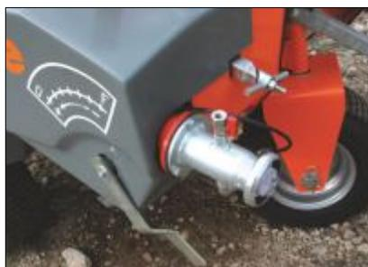
Réglage vitesse d'avancement par by-pass
