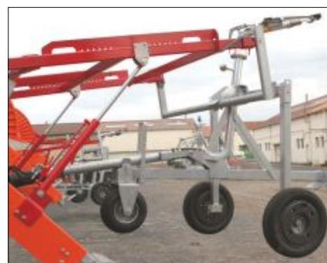
Relevage hydraulique série 2000 à commande indépendante en option
