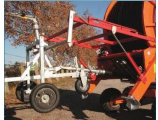
Traîneau série 2000 & cadre relevage hydraulique
