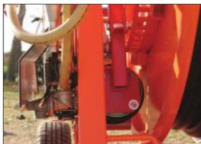
Bras moteur actionné par soufflet pneuride 8"
