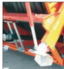
Cric avant escamotable Bêches hydrauliques
