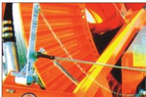
Régulation mécanique de vitesse d'avancement
