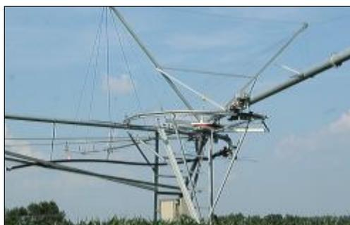
Ce système optimise les surfaces irriguées par pivot, en permettant d'éviter des obstacles, bois, poteaux, hangars, etc...
