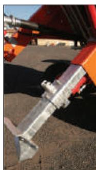
Dispositivos de anclaje y Rotación torreta hidráulicas
