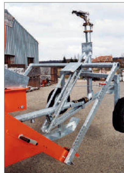
Levantamiento automático del trineo articulado
