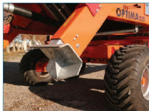
Patas de anclaje hidráulicas
