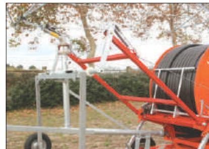
Enganche trineo automático en fin de riego
