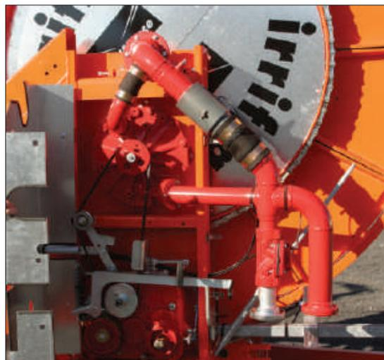
Válvula de descarga o válvula de parada
