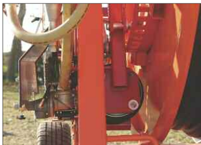
Обводной рычаг приводится в действие сифлоном pneuride 8"
