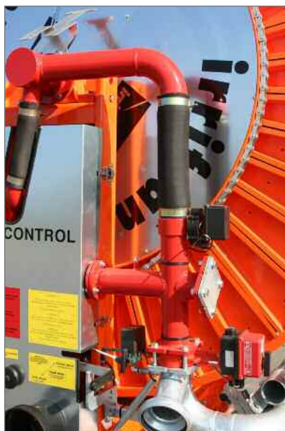
Патрубок питания с интегрированным клапаном
