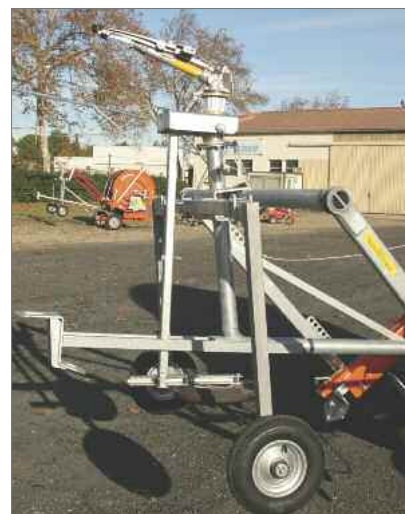
Подъем мобильного маятникового устройства
