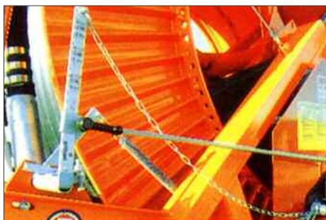
Механическая регулировка скорости продвижения
