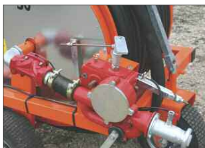
Низкоскоростная турбина на коробке передач
