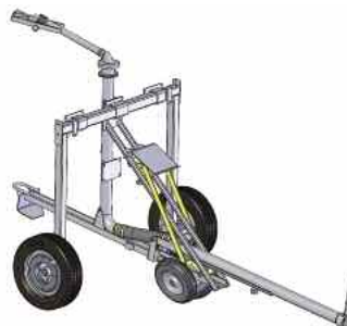
Мобильное устройство с клиренсовым механизмом с регулируемой колеей (поз. B45541)
