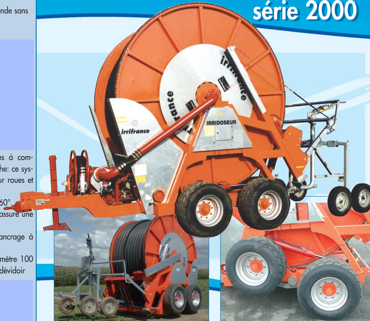
Traineau 4 roues, relevage hydraulique
