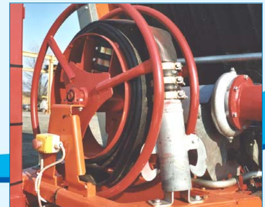
Dévidoir flexible alimentation
